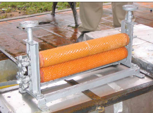
Walze zum Pressen von Mittelwänden.
